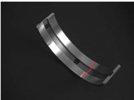
Groove width / groove depth
